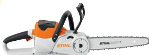
Motosierra a batería ligera para el cuidado del jardín y actividades artesanales. Empuñadura blanda, cambio de cadena rápido y cómodo mediante tensado rápido de cadena STIHL, freno de cadena QuickStop Super, depósito de aceite con ventanilla transparente, alto rendimiento de corte mediante cadena de PM3 de 1/4", peso 2,7 kg<sup>®</sup>.
