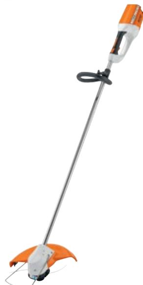
Motoguadaña a batería para trabajos de corte a lo largo de obstáculos y alrededor de árboles y pequeños arbustos. Diámetro de la circunferencia de corte 350 mm, manillar ajustable en progresión continua, ajuste del manillar sin herramientas, el cabezal de corte permite bobinar hilo nuevo golpeándolo suavemente contra el suelo, regulación continua del régimen de revoluciones, distancia-dor, peso 2,8 kg<sup>②</sup>.
